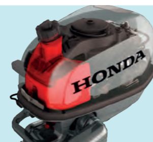
Die BF-Motoren sind speziell für die Aufnahme eines integrierten Kraftstofftanks (1,5 l) konzipiert.
